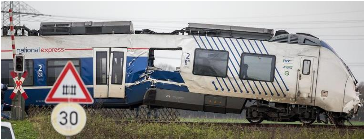
Fig.11: Schadensbild des führenden Wagens – nach Anheben bei der Bergung [5]
