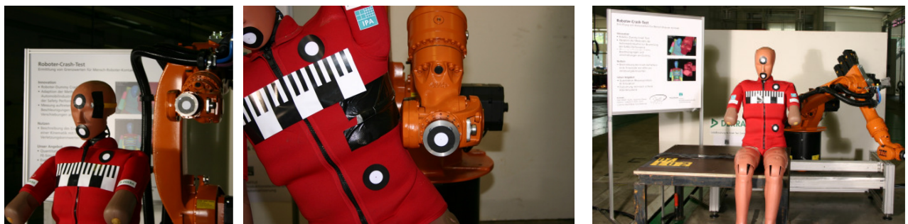
Bild 3: Crash Setup mit KUKA KR16 und ES-1 im Crash Center der DEKRA
