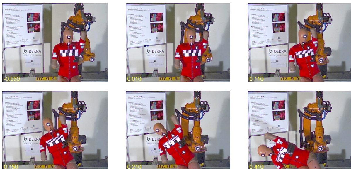
Bild 7: Roboter Impact gegen die Brust des ES-1 mit der Highspeed-Kamera aufgenommen
