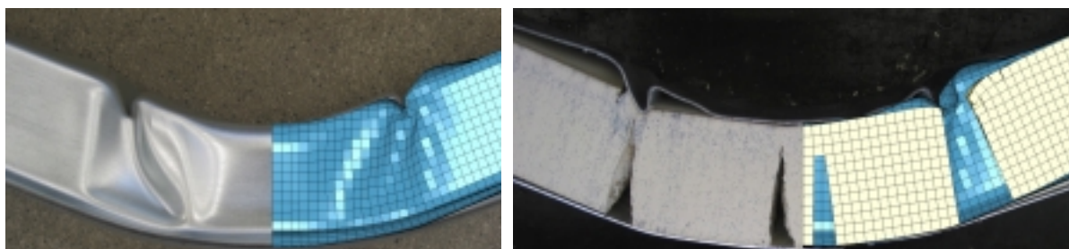
Bild 8: Mit einem eingeschobenen Kern aus Polyurethanschaum versehenes Profil aus DP600 nach dem Komponententest in Draufsicht (links) und im Schnitt, jeweils mit Überlagerung des Simulationsergebnisses.
