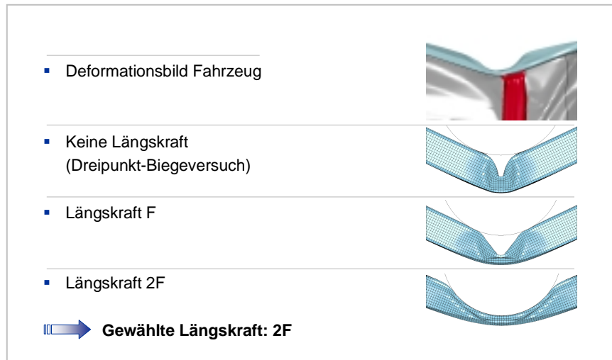
Bild 5: Bestimmung der benötigten Längskraft
