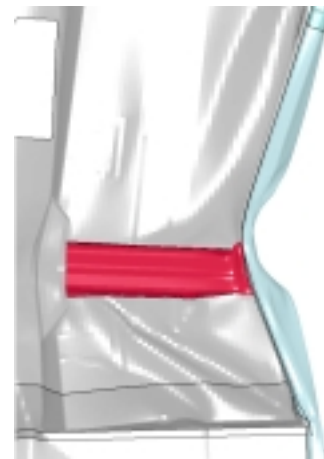
Bild 2: Deformation der Bodenstruktur eines Fahrzeugs
